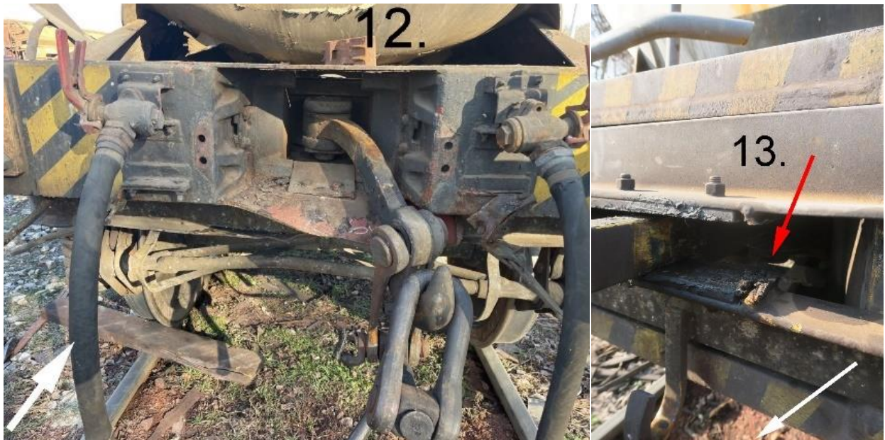
Слика 4.2.1.6: Деформисане куке и вођице између дванаестих и тринаестих кола
