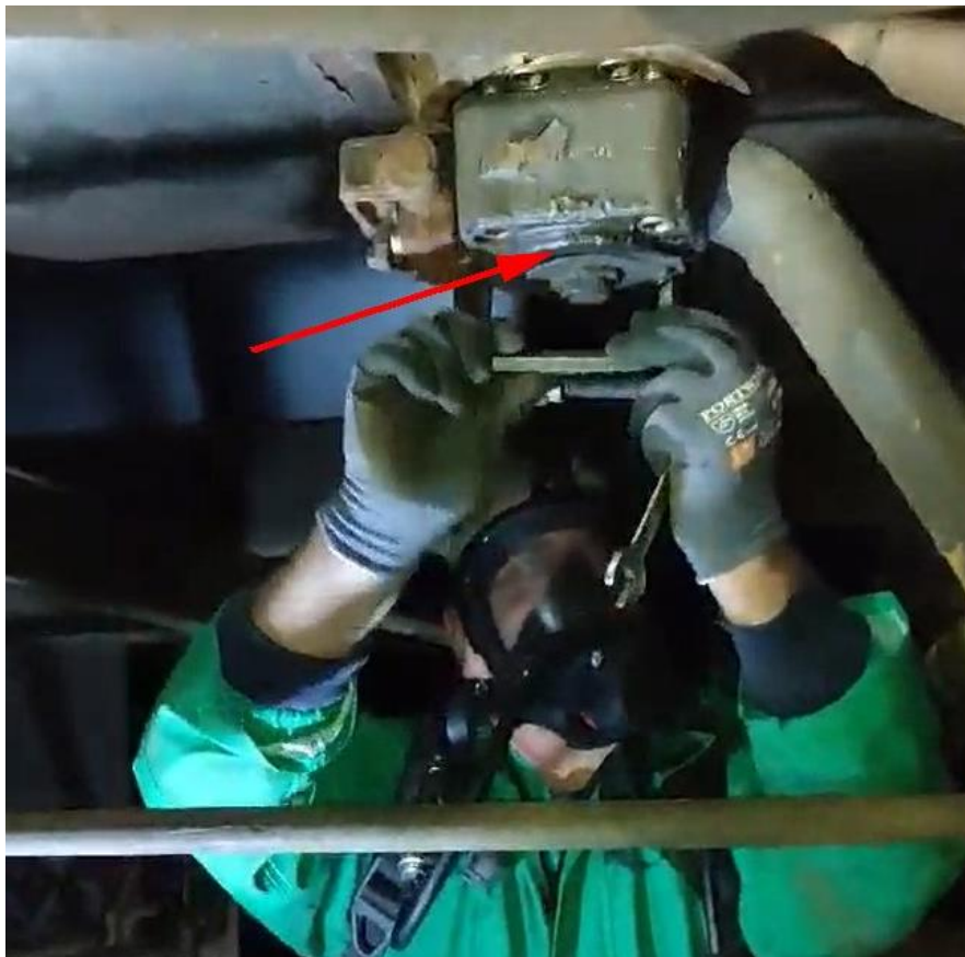
Слика 4.2.5.2.1: Место цурења амонијака на седмим колима број 33 87 7813 561-0
