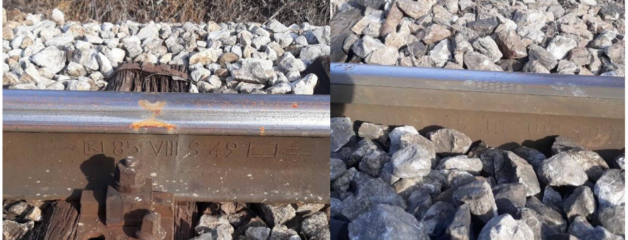
Слика 3.4.2.1: Изглед шина типа „49Е1“ ZENICA 85 и 86 UIC 49 (извор: „ИЖС“ а.д.)
