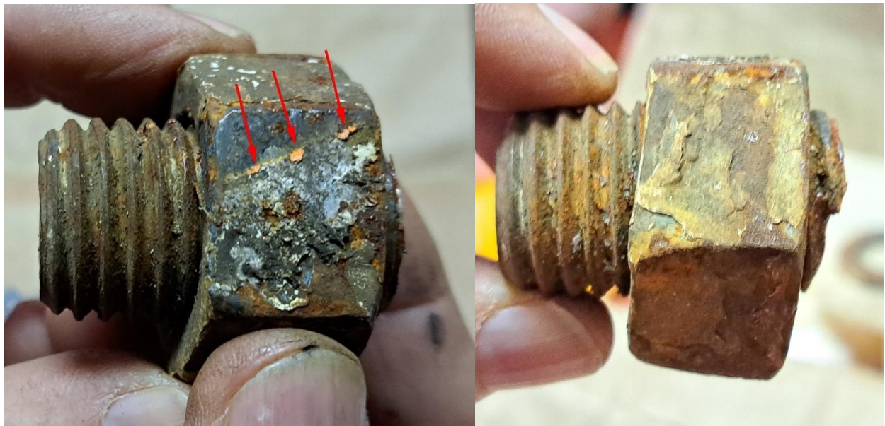
Слика 4.2.1.11: Изглед пронађених откинутих вијака
